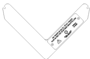
Vedstopper med informasjonsskilt
