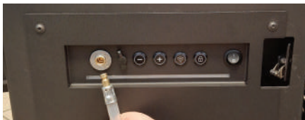
Rys. 20 Hurtigkobling for drivstoffpåfylling med tilhørende kobling for ekstern pumpe
