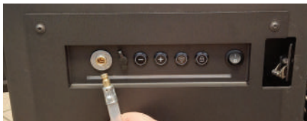
Rys. 21 Strømuttak for ekstern pumpe med tilhørende støpsel fra den eksterne pumpen
