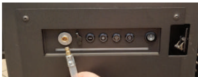
Fig. 27 Raccord rapide du réservoir de carburant avec le raccord correspondant pour la pompe externe
