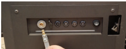
Fig. 27 Connettore rapido per il rifornimento del combustibile con il connettore corrispondente della pompa esterna
