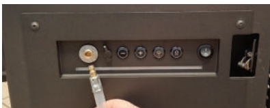
Abb. 27 Schnellkupplung des Brennstoffeinfüllstutzens zusammen mit dem passenden Anschluss der externen Pumpe
