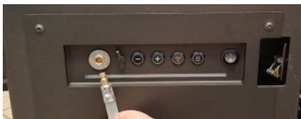
Fig. 28 Strømuttak for ekstern pumpe med tilhørende støpsel fra den eksterne pumpen
