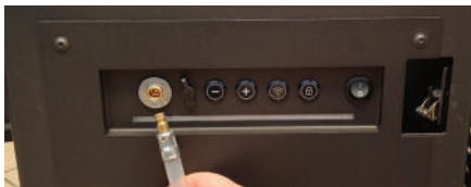
Rys. 27 Szybkozłącze wlewu paliwa wraz z pasującym złączem pompy zewnętrznej
