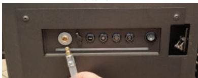
Fig. 28 Prise d'alimentation de la pompe externe avec la fiche correspondante provenant de la pompe externe
