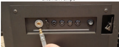
Abb. 28 Stromversorgungsbuchse der externen Pumpe zusammen mit dem passenden Stecker der externen Pumpe
