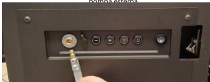
Fig. 28 Presa di alimentazione della pompa esterna con la spina corrispondente della pompa esterna
