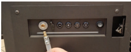
Rys. 28 Gniazdo zasilania pompy zewnętrznej wraz z pasującą wtyczką z pompy zewnętrznej
